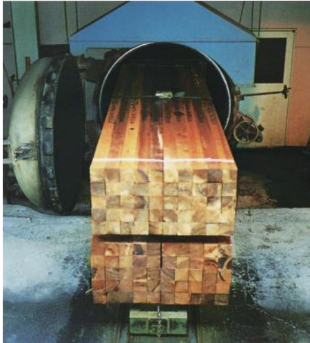
工場での防腐・防蟻処理
